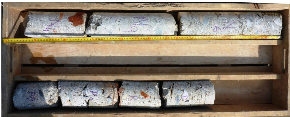
Vzorky jádrových vrtů, vybrané pro laboratorní zkoušky.
